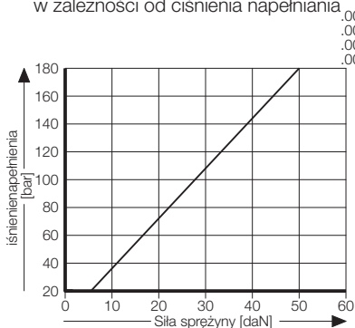
Początkowa siła sprężyny w zależności od ciśnienia napełniania
